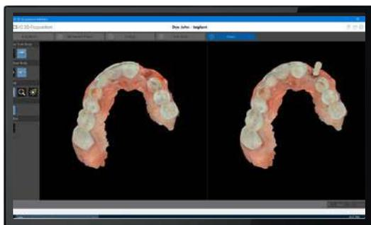
Il modo Dual Scan permette di scansionare la stessa regione d'interesse implantare due volte — una con lo scanbody inserito e una senza — per acquisire dati più precisi.
