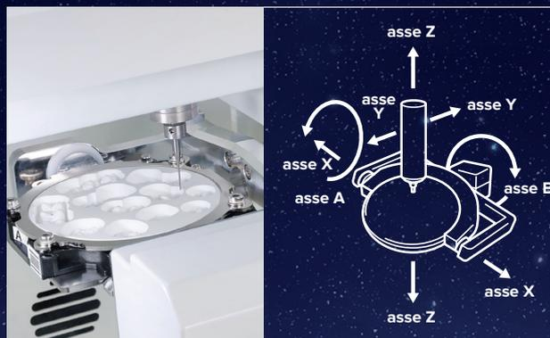
Il telaio e l'utilizzo di viti a ricircolo di sfere consentono movimenti più morbidi e assicurano una maggiore stabilità della macchina in fase di lavorazione. DWX-52DC calibra i cinque assi automaticamente prima della fresatura. È fornita di un sistema di aria compressa che varia automaticamente a seconda del tipo di materiale fresare.
