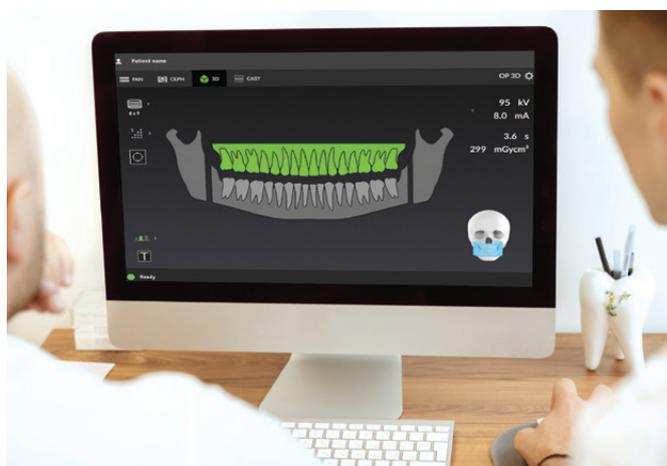
L'area di interesse può essere selezionata intuitivamente con la funzione ORTHOselect. I denti possono essere selezionati singolarmente, oppure, più in generale, come arcata superiore, inferiore o ATM. Il Campo di Vista ottimale viene impostato automaticamente in base alla selezione effettuata.
